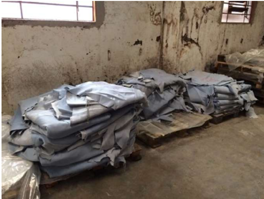
Figura 2 – Couro em estado Wet-Blue Fonte: Foto tirada por Bárbara Oliveira Rosa (2018).
